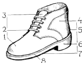
Рис. 189. Мужской ботинок: 1 — носочная часть; 2 — заклепка; 3 — язычок; 4 — берец; 5 — пяточная часть; 6 — каблук; 7 — подошва; 8 — рант
