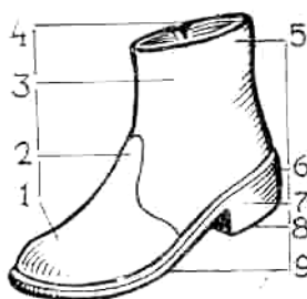
Рис. 188. Мужской полусапожек: 1 — носочная часть; 2 — подъемная часть; 3 — голенище; 4 — застежки; 5 — верхняя часть голенища; 6 — каблук; 7 — верхняя часть каблука; 8 — нижняя часть каблука; 9 — подошва
